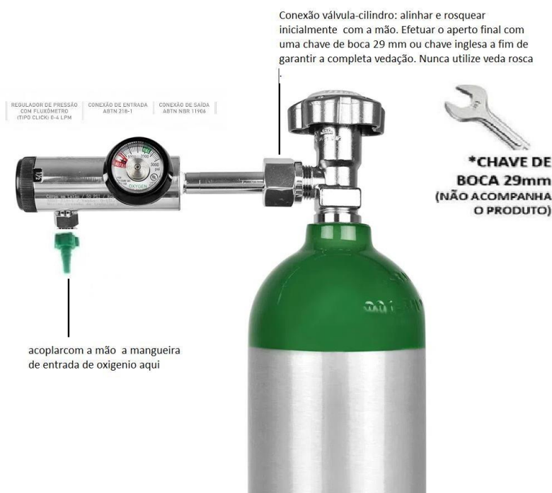
Figura 15 — Conexão válvula-cilindro de Oxigênio
